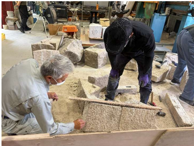
石工科:石積み(仮組み、合場加工)
