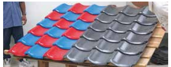
▲演習前に実際にねじれ方向の異なる棧瓦を配置し、隙間がどのように空くかを確認。隙間が大きいほど雨漏りのリスクが高くなり、交互に葺くことで隙間が少なくなる。
