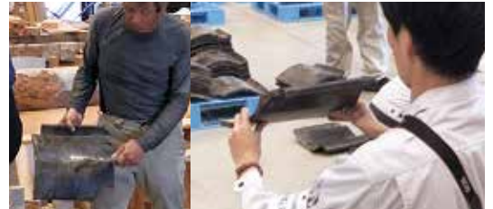
▲打音検査→瓦の全体を叩いた目で目に見えないひびを探す。 ▲ねじれ方向の確認→「しり」を左側に「手前」側からみて跳ね上がっている方向を目視で確認・仕分する。
