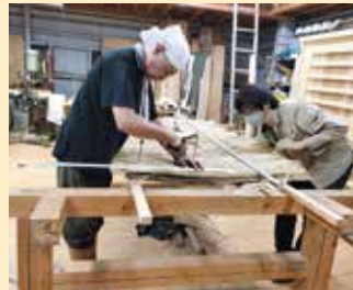
▲糸に食用油を塗って、滑りやすく、かつ切れにくくします。糸は、昔は麻糸でしたが、今は化学糸です。
