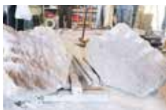
◀この石を割るのに矢を上4箇所、横に2ヶ所穿つ。矢を穿つ穴1つ開けるのに、1.5kgのハンマーで30分程かけて1000回位、叩く。
