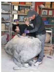
◀この石を割るのに矢を上4箇所、横に2ヶ所穿つ。矢を穿つ穴1つ開けるのに、1.5kgのハンマーで30分程かけて1000回位、叩く。
